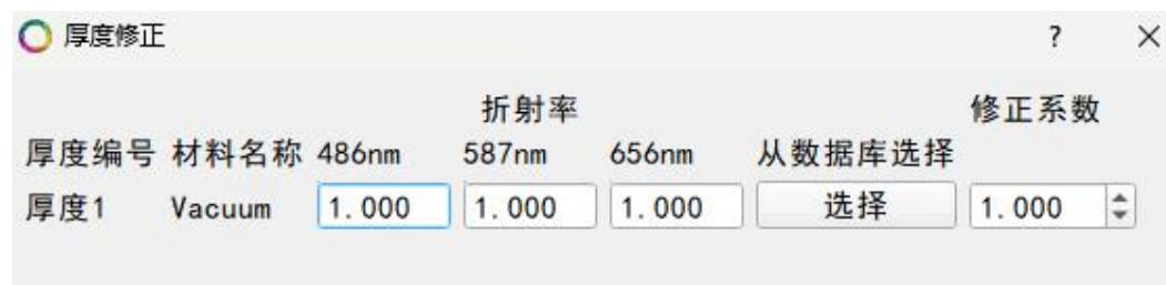
图 5- 17 单层测厚模式下折射率与修正系数
