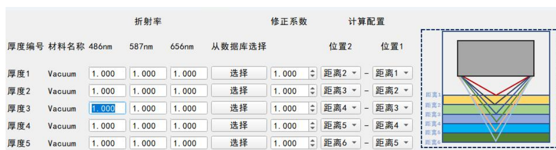
图 5- 18 多层测厚下折射率选择、厚度修正、计算来源配置
