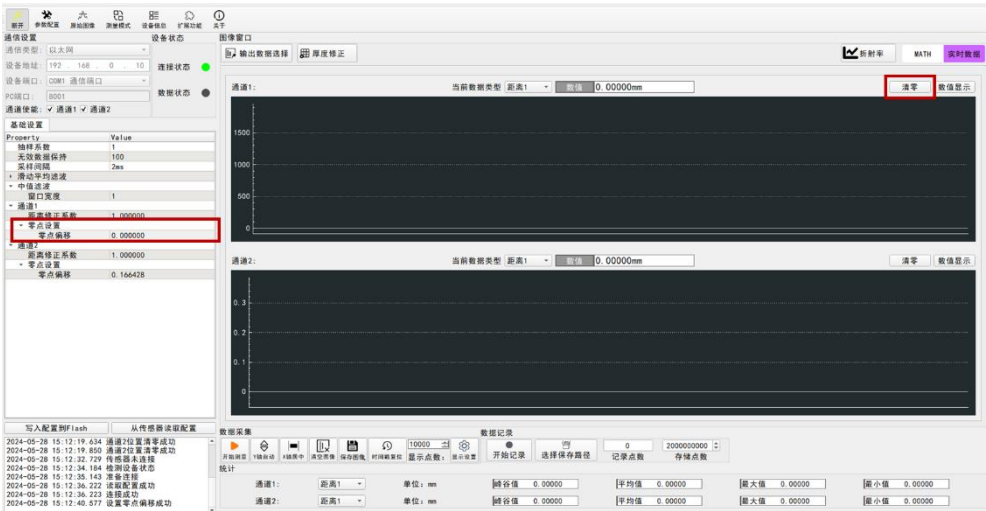
图 5- 19 多层测厚模式下零点设置及清零按钮位置
