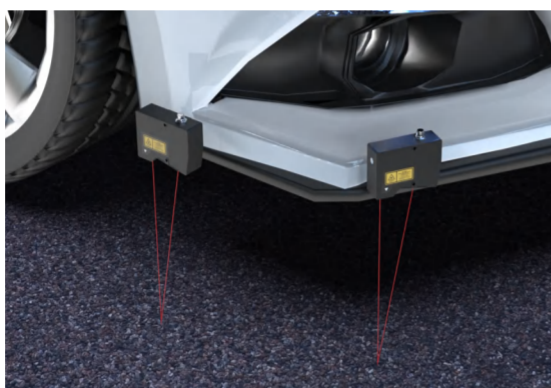
◆ 道路平整度测量
