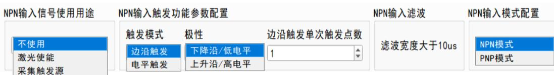
图 4-37 NPN 输入触发功能参数配置
