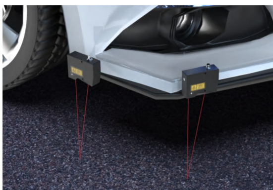
◆ 道路平整度测量
