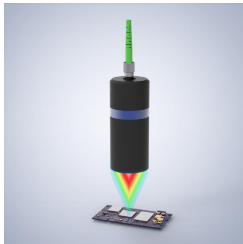
◆ PCB零件高度差测量
